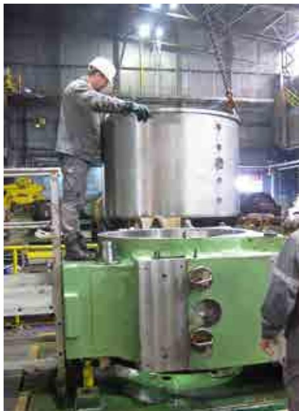
Einsetzen einer Lagerbuchse
